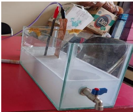
Pengondisian Limbah Cair Sebelum dikontakkan dengan alat elektroflokulasi
