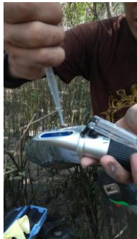
Pengukuran salinitas dengan refraktometer.
