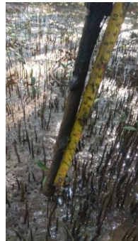
Pengukuran ketebalan lumpur dengan tongkat.
