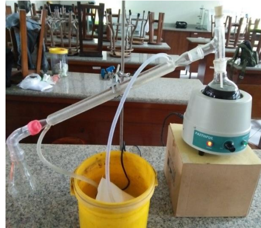
Proses Destilasi Hasil Meserasi Simplisia
