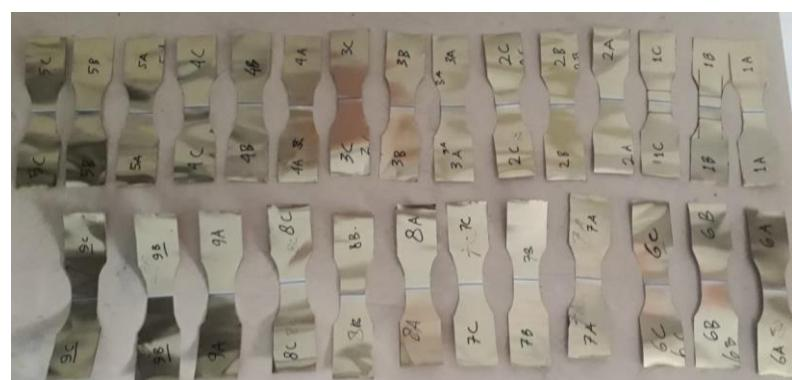
b. Spesimen material setelah selesai uji tarik
