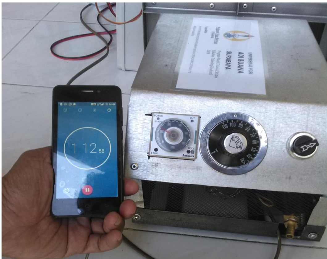
Gambar Pengujian Timer ( Pengatur Waktu ) Dengan stopwatch
