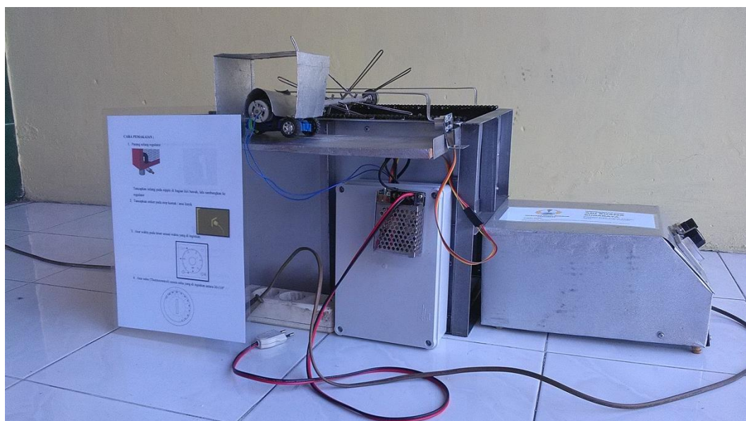
Gambar Prototype Mesin Pengering Gabah Dengan Pengaduk Otomatis Berbasis Arduino
