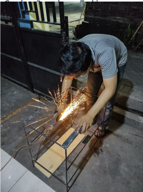
Gambar Pemasangan Tempat Turbin
