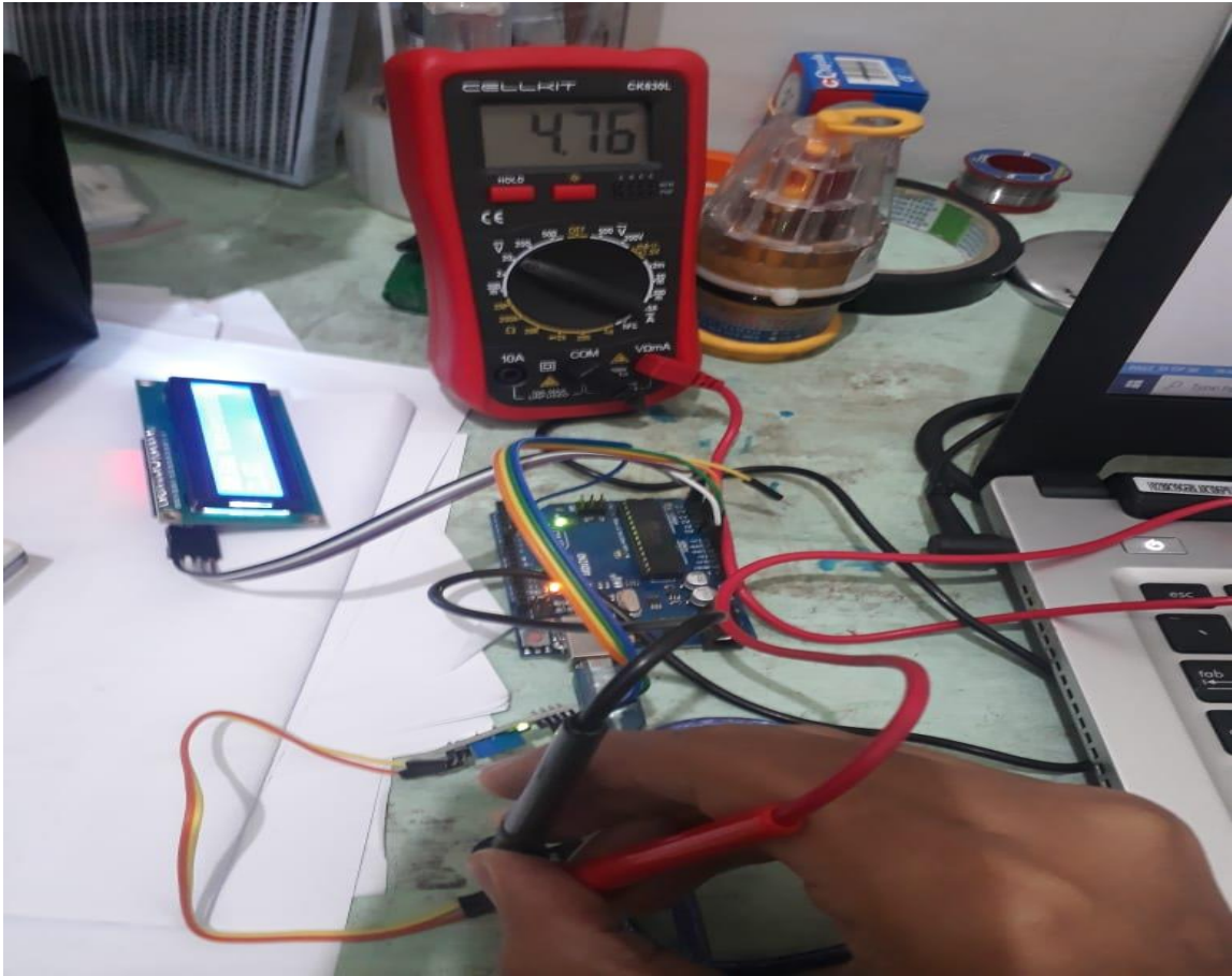
Pengujian keluaran catu daya 5VDC
