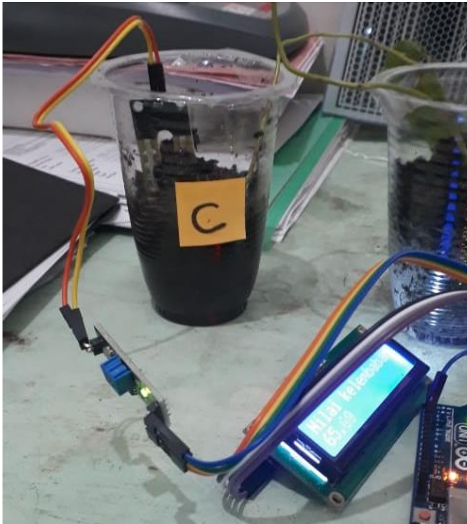
Pengujian sensor kelembaban
