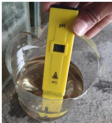
o. Pengukuran pH pada bambu air vol akar 40 ml
