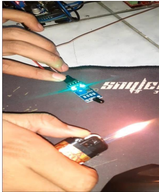
Lampiran 4.2.7 Uji Coba Sensor Dengan Api
