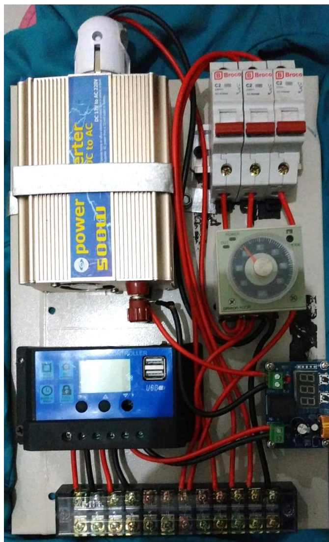
Gambar penyusun kelistrikan sistem PLTS
