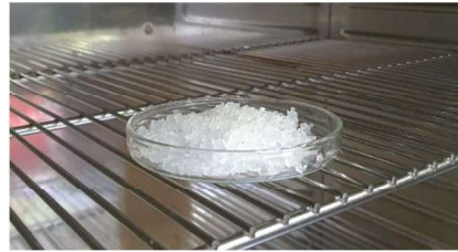
Proses pengovenan kristal Tawas yang telah dicuci alkohol
