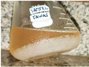
Terbentuk endapan kristal Tawas
