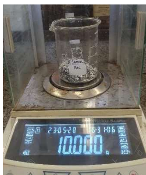
Proses Menimbang Limbah Kemasan Strip Obat 10 gram untuk PAC
