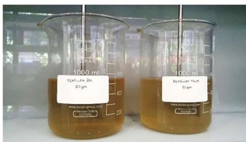
Proses Koagulasi - Flokulasi Limbah Cair Domestik
