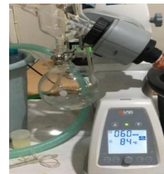
Gambar L 3.(c) Pemekatan ekstrak dengan vacuum rotary evaporator
