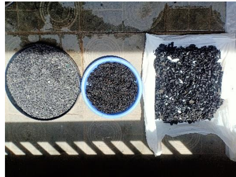
Penjemuran media karbon aktif sekam padi, kulit singkong, dan tempurung kelapa
