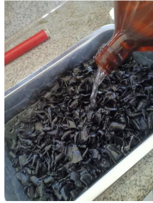
Perendaman karbon aktif dengan NaOH 2N setelah difurnace
