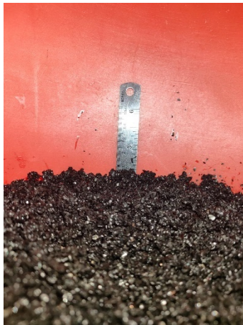
Gambar 3. Pengukuran ketinggian media karbon aktif.
