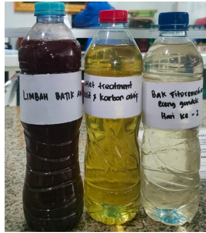
Gambar 13. Perbandingan limbah awal, pasca adsorpsi, dan kombinasi adsorpsi dan fitoremediasi
