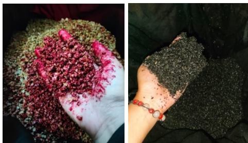
Gambar 14. Kondisi adsorben zeolit dan karbon aktif setelah adsorpsi
