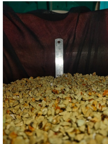
Gambar 4. Pengukuran ketinggian media zeolite.
