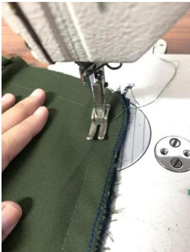
**Gambar 5.5 Menjahit Sisi Luar Celana dan Sisi Dalam**
