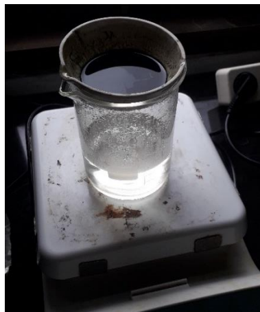
Pengentalan ekstrak menggunakan hotplate
