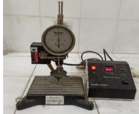
Diuji dengan alat penetrometer
