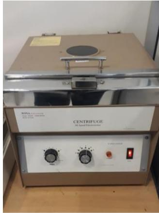
Sampel yang sudah dimasukkan ke tabung reaksi akan dimasukkan ke dalam *Centrifuge* untuk proses homogen
