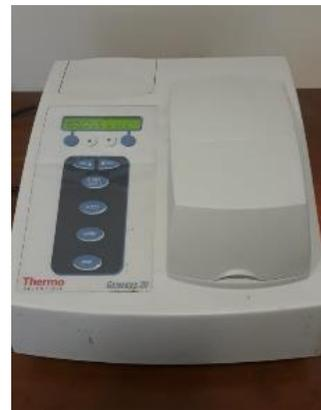
*Kufet* dimasukkan ke dalam *Spektrofotometer* agar memperoleh kadar klorofil
