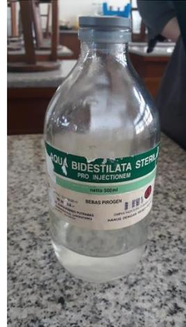
Aqua bides digunakan untuk pelarut pada proses penghalusan sampel
