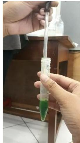
Proses mengambil sampel yang sudah larut dengan pipet yang akan dimasukkan ke tabung reaksi
