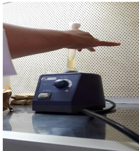
Gambar 16. Proses Homogen Pengencer BPW dengan Vortex
