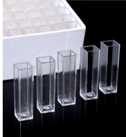
Kuvet (wadah untuk menampung larutan sampel)
