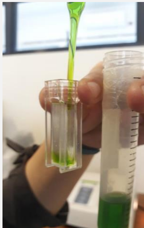
Proses penuangan sampel klorofil pada kuvet
