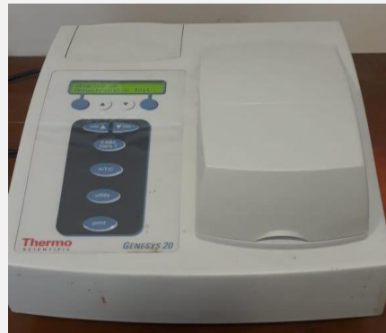
Kuvet dimasukan pada spektrofotometer untuk diukur gelombang cahaya antara klorofil a dan klorofil b sehingga didapatkan kadar klorofil total
