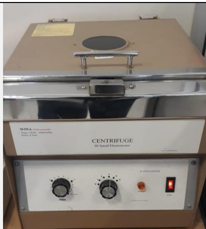
Proses pemisahan antara ampas daun yang tersisa dengan larutan klorofil menggunakan centrifuge
