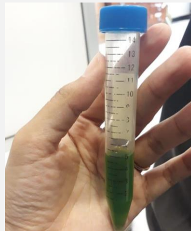
Tabung yang berisi larutan klorofil setelah dikeluarkan dari centrifuge
