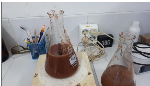
Proses aktivasi dengan penambahan Larutan HCl 1M + magnetic stirrer
