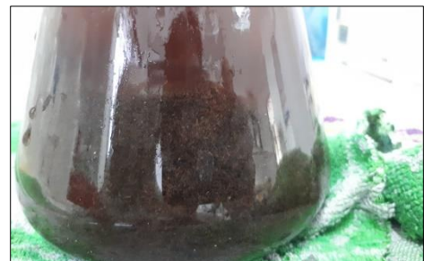
Proses perendaman dengan Larutan NaOH 1 M selama 24 Jam
