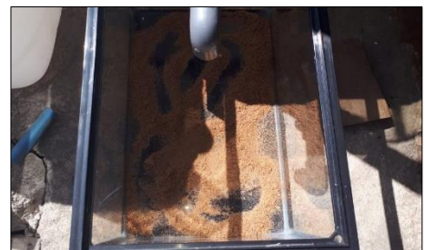
Adsorben yang telah jadi diletakkan pada reaktor
