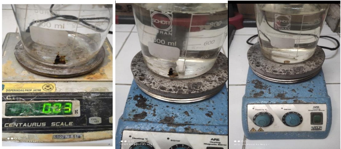
Proses Desinfeksi Air Sumur Pagi Hari dengan Ekstrak Daun Kelor 30 mg dan Waktu Pengadukan 30 Menit
