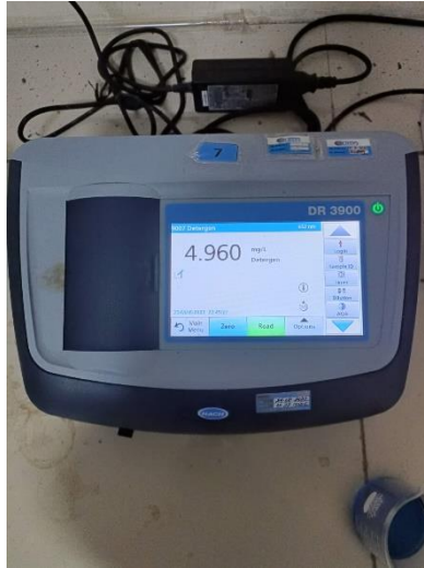
Hasil Uji Detergen Sampel Air Limbah Industri Sabun Dengan Pengenceran 5x
