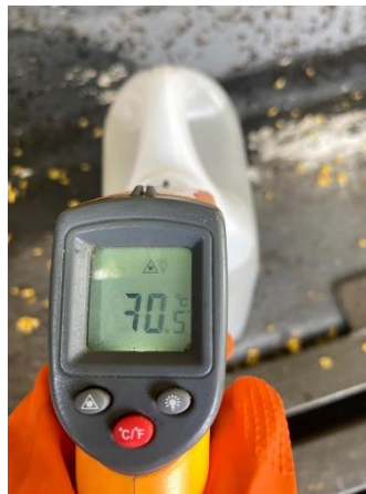
Hasil Uji Suhu Sampel Air Limbah Industri Sabun Menunjukkan Angka 30,5°C
