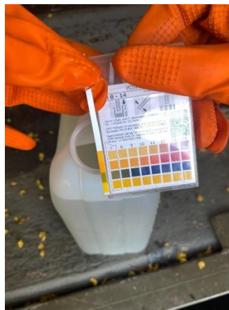
Hasil Uji pH Sampel Air Limbah Industri Sabun Menunjukkan Angka pH 7,0
