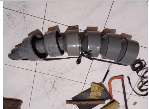
Perangkaian Tutup Inlet Outlet Reaktor Ferrolite
