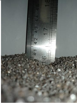
Pengukuran Ketinggian Media Ferrolite
