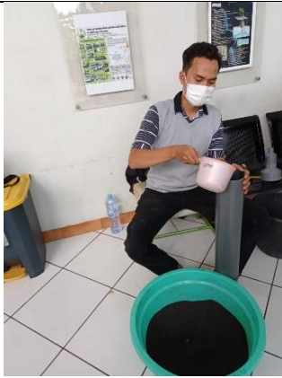
Pengisian Reaktor dengan Media Ferrolite
