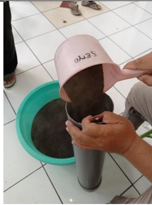
Pengisian Reaktor dengan Media Ferrolite
