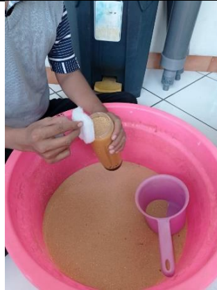
Pengisian Catridge Housing Filter dengan Media Resin
