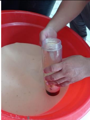
Pengisian Catridge Housing Filter dengan Media Resin
