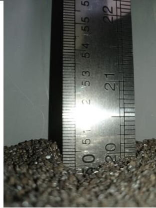
Pengukuran Ketinggian Media Ferrolite
