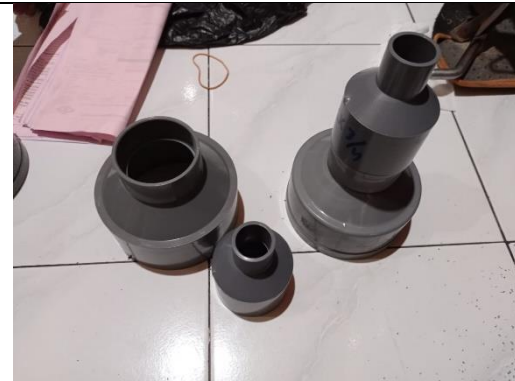
Perangkaian Tutup Inlet Outlet Reaktor Ferrolite
