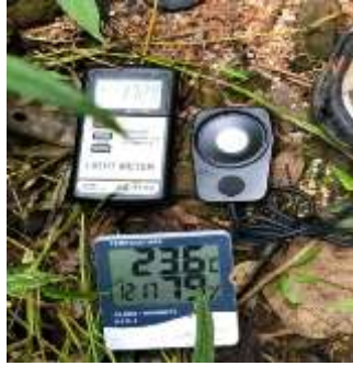
Alat ukur intensitas cahaya ( Luxmeter ) dan alat ukur suhu dan kelembaban udara ( Thermohygrometer )
