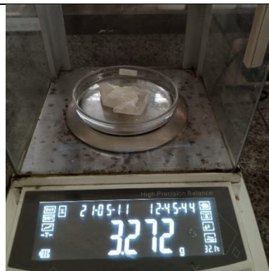
PROSES MENIMBANG BERAT SAMPEL SAAT Uji BIODEGRADASI
