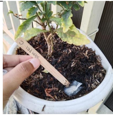
PROSES Uji BIODEGRADASI MENGGUNAKAN MEDIA TANAH
