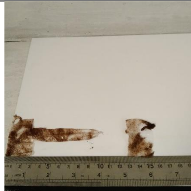
PROSES Uji KUAT TARIK DAN Uji PEMANJANGAN SAAT PUTUS
