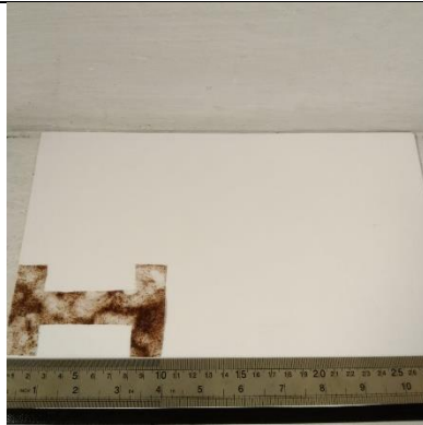
PROSES Uji KUAT TARIK DAN Uji PEMANJANGAN SAAT PUTUS
