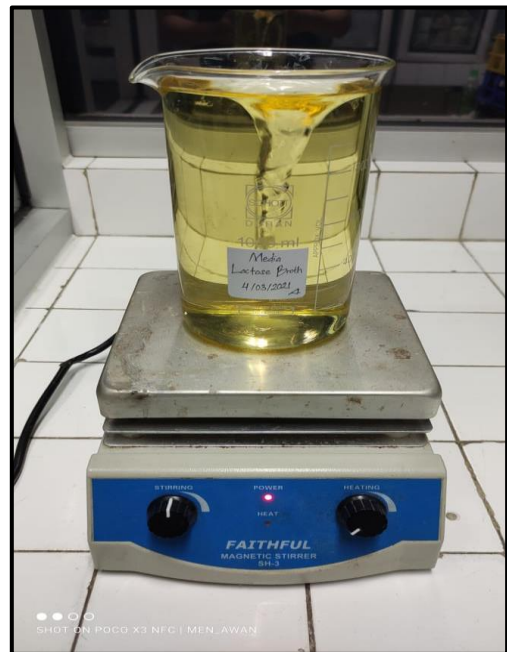
Melarutkan media Lactose Broth menggunakan magnetic stirrer di atas hot plate
