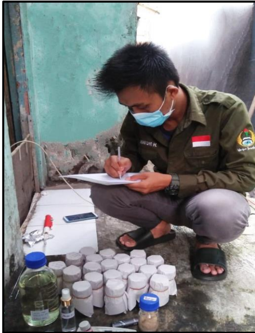
Persiapan botol schott 100 ml steril, pinset, pembakar alkohol, korek sebagai alat sampling mikrobiologi
