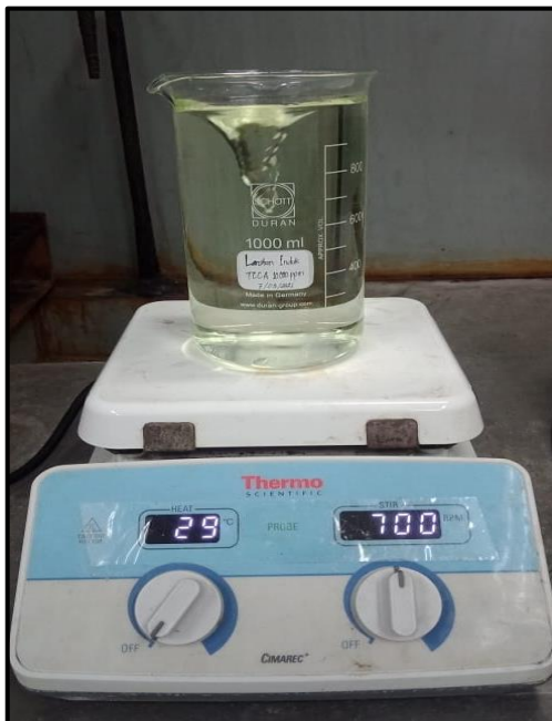
Proses pengadukan larutan induk TCCA 10.000 ppm diatas hot plate
