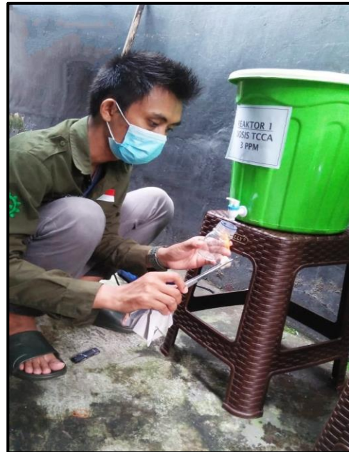
Melakukan sampling secara aseptis pada air hasil pengolahan untuk parameter uji mikrobiologi
