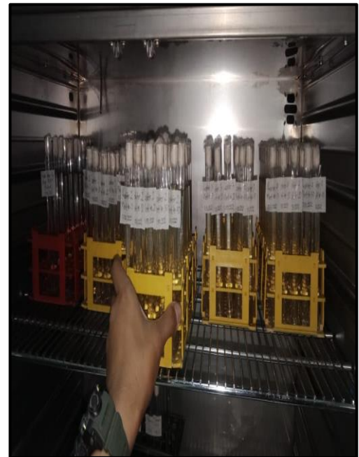
Menginkubasi dalam inkubator pada suhu 35 \pm 0.5 °C selama 48 \pm 2 jam sebagai uji pendahuluan
