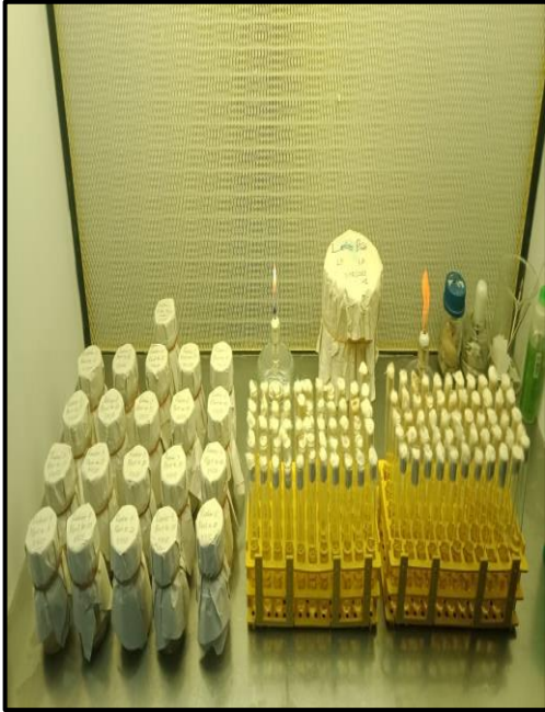
Persiapan alat dan bahan dalam meja kerja Laminair Air Flow steril untuk analisa Total coli dan E. coli
