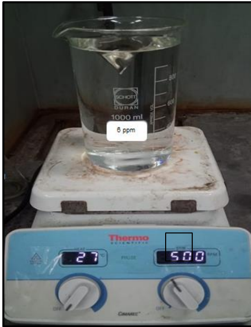
Proses pengadukan pada percobaan dosis TCCA 6 ppm diatas hot plate
