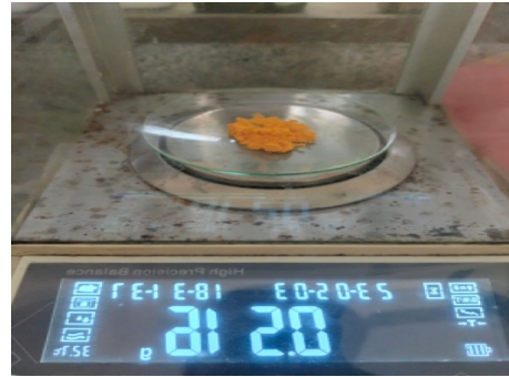
Proses Penimbangan Dosis Biokoagulan Serbuk Kulit Jeruk Manis
