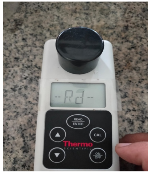
Pengujian Kadar Kekeruhan Menggunakan alat Turbiditymeter
