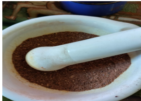
Proses Penumbukan Kulit Biji Asam Jawa menggunakan Alu dan Mortar
