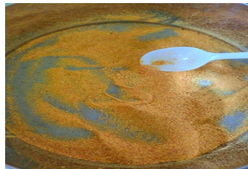
Proses Pengayakan Bubuk Kulit Jeruk Manis menggunakan Ayakan Ukuran 100 Mesh
