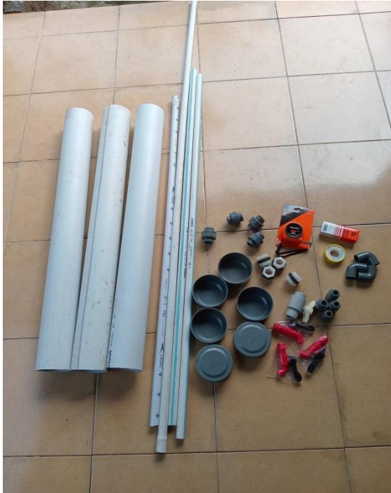
Menyiapkan alat dan bahan untuk membuat reaktor
