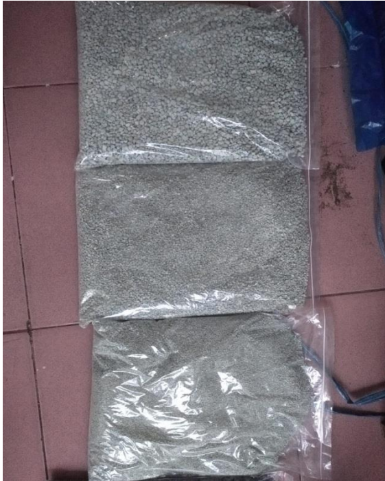
Menyiapkan media filter zeolit yang telah dicuci dan dikeringkan
