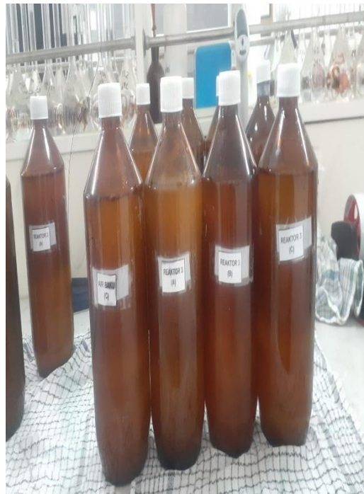
Menyimpan pada botol gelap untuk pengujian parameter minyak lemak di Laboratorium Lingkungan DLH Jatim
