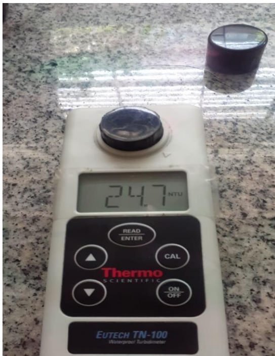
Melakukan analisa kekeruhan dengan alat turbidimeter
