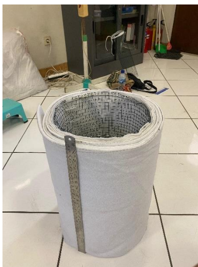
Keranjang filter tinggi 50 cm
