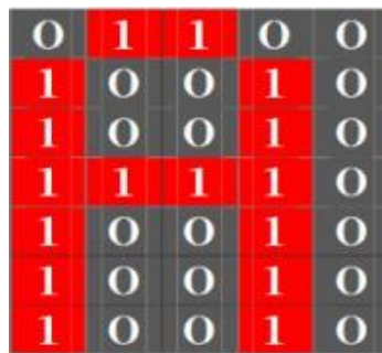
Gambar 2. 19 Contoh Huruf A Pada Led Dot Matrix.
